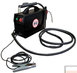
Le poste de découpage plasma est un outil désormais indispensable pour découper les nouvelles tôles acier, trop dures pour être coupées avec les moyens traditionnels, ou les panneaux aluminium. Son système Inverter offre une qualité de coupe de grande précision jusqu'à 4mm d'épaisseur et une coupe de séparation jusqu'à 5mm.
