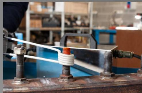
Le poste à induction ARO DUCTOR a été spécialement conçu pour les travaux de réparation automobiles : il est utilisé partout dans l'atelier, en carrosserie comme en mécanique. Il vous fera gagner un temps précieux pour démonter un goujon bloqué ou décaper un élément.
