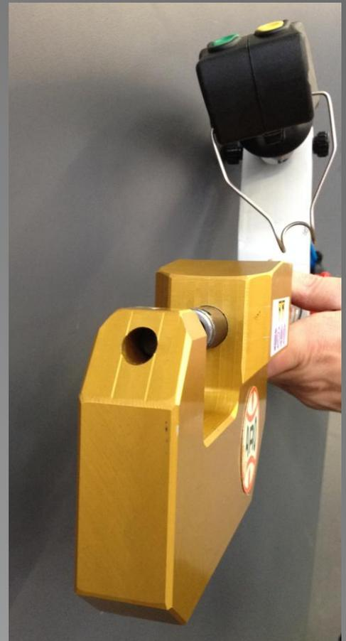
La riveteuse ARO RV-1 permet de poser des rivets de diamètre 3.5, 5.3 et 8mm, d'extraire des rivets posés et de percer les tôles.
